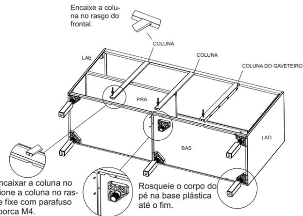
Depois de encaixar a coluna no rasgo do frontal posicione a coluna no rasgo da base e fixe com parafuso M4x6mm e porca M4.
