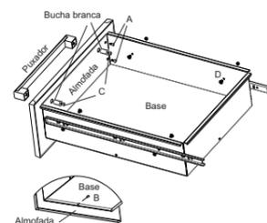
3) Fixe os parafusos A (3,5x9,5) na almofada, travando a gaveta. Utilize o parafuso B (3,5x9,5) para fixar a base na almofada. Encaixe a bucha branca e os parafusos C (3,5x9,5) juntos, no furo da almofada. Posicione o puxador e aperte os parafusos. Posicione o trilho menor, alinhando-o sobre os furos da lateral do gavetão. Utilize os parafusos D (M4x6) e as porcas M4 para fixar.
